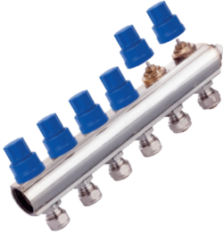
► Termostatik Salmastralı Kollektör 1" 16x2 (PN 10)
